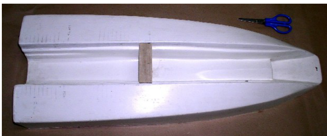
شکل ۷- مدل هیسوکت با آرایش تک هیدروفویلی
