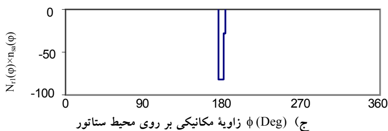
شکل ۱- فاصله مراحل مربوط به محاسبه اندوکتانس L_{ar1} :
