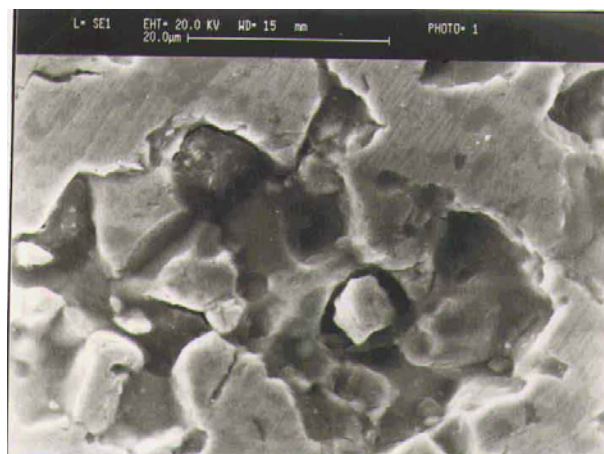
شکل ۷- تصویر SEM از الکترونهای برگشتی نمونه Fe-10% Ti-3%C در حالت سرمایش و برگشت شده بعد از سائیده شدن به مسافت ۷۰۰ متر
