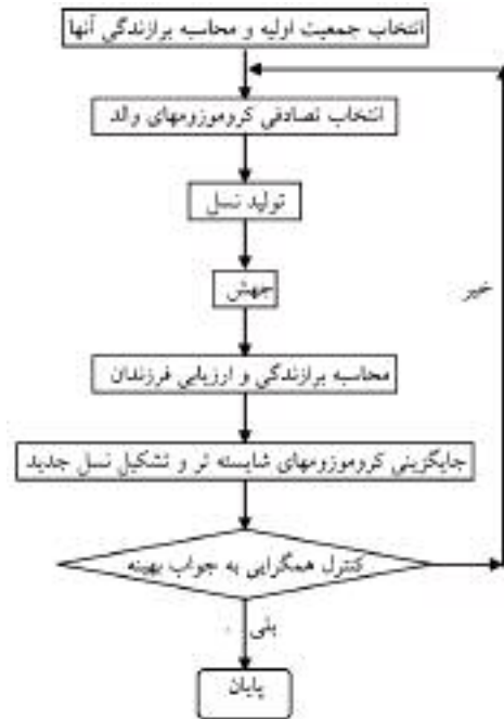
شکل ۲ - فرایند به کارگیری الگوریتم ژنتیک
