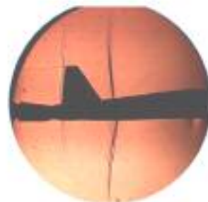
شکل ۳-ه) موج ناپایا در انتهای مدل با دم عمودی دوتایی در زمان راه اندازی تونل، \alpha=0
