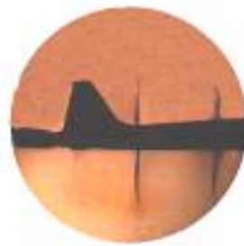
شکل ۳-الف) موج ناپایا در انتهای مدل با یک دم عمودی در زمان راه اندازی تونل، \alpha=0
