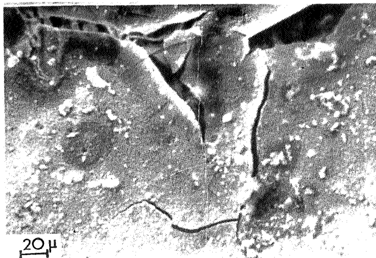
شکل ۱۵ : تصویر میکروسکوپی الکترونی از رسوبات ضخیم و غنی از آرسنیک که بر روی سطح نمونه خوردگی تنش تشکیل شده و ترک خورده اند . محلول : محلول پایه حاوی 500ppm آرسنیک سرعت کشش : 3/3 \times 10^{-2} میکرون بر ثانیه
