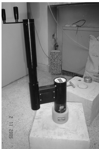
شکل ۵- آزمایش کشش مستقیم
