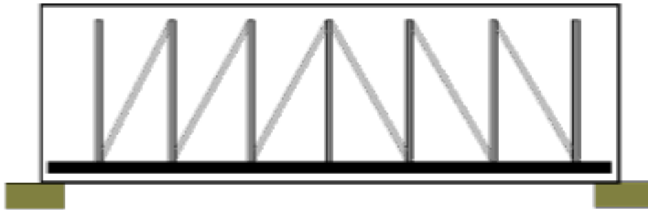
شکل ۱- مدل تشابه خرپایی ریتر ۱۸۹۹
