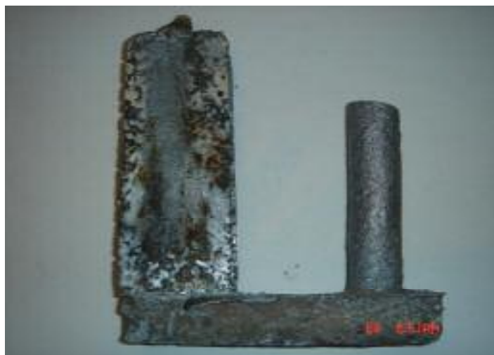
شکل ۵- نمایی از اولین قطعه تولید شده به روش حاضر که پر از حفره و سوراخ است.
