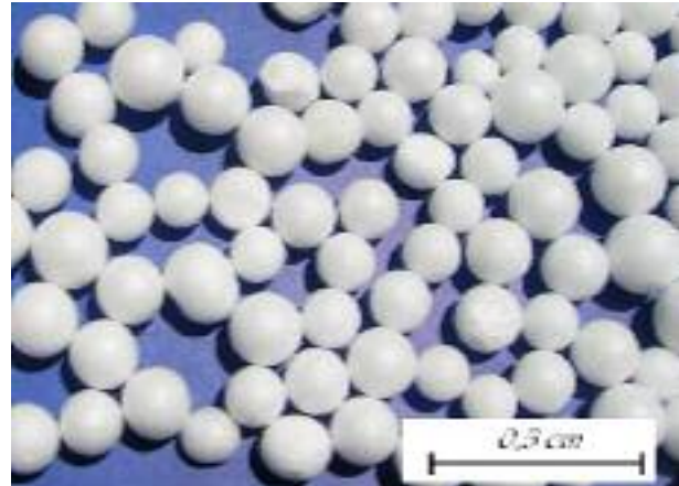
شکل ۱- تصویر دانه‌های فومی پیش‌شکفته مورد استفاده در ساخت ملاط فومی.
