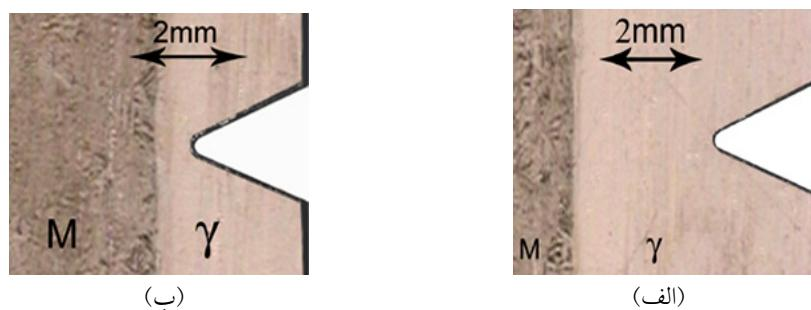
شکل ۳- فاصله نوک شیار از لایه مارتنتزیتی در کامپوزیت  $\gamma\text{M}\gamma$ . نزدیک شدن شیار به لایه مارتنتزیتی کاهش مقاومت به ضربه کامپوزیت را به همراه دارد.
