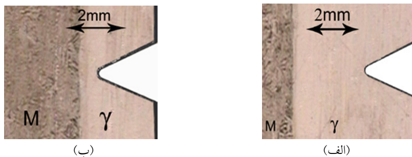
شکل ۳- فاصله نوک شیار از لایه مارتنزیتی در کامپوزیت \gamma M\alpha : نزدیک شدن شیار به لایه مارتنزیتی کاهش مقاومت به ضربه کامپوزیت را به همراه دارد.
