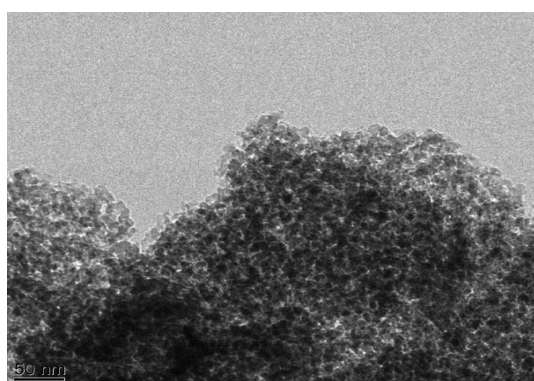
شکل ۱- تصاویر تهیه شده توسط TEM از نانو پودرهای تولیدی کلسینه شده در دمای ۶۰۰ درجه سانتیگراد
