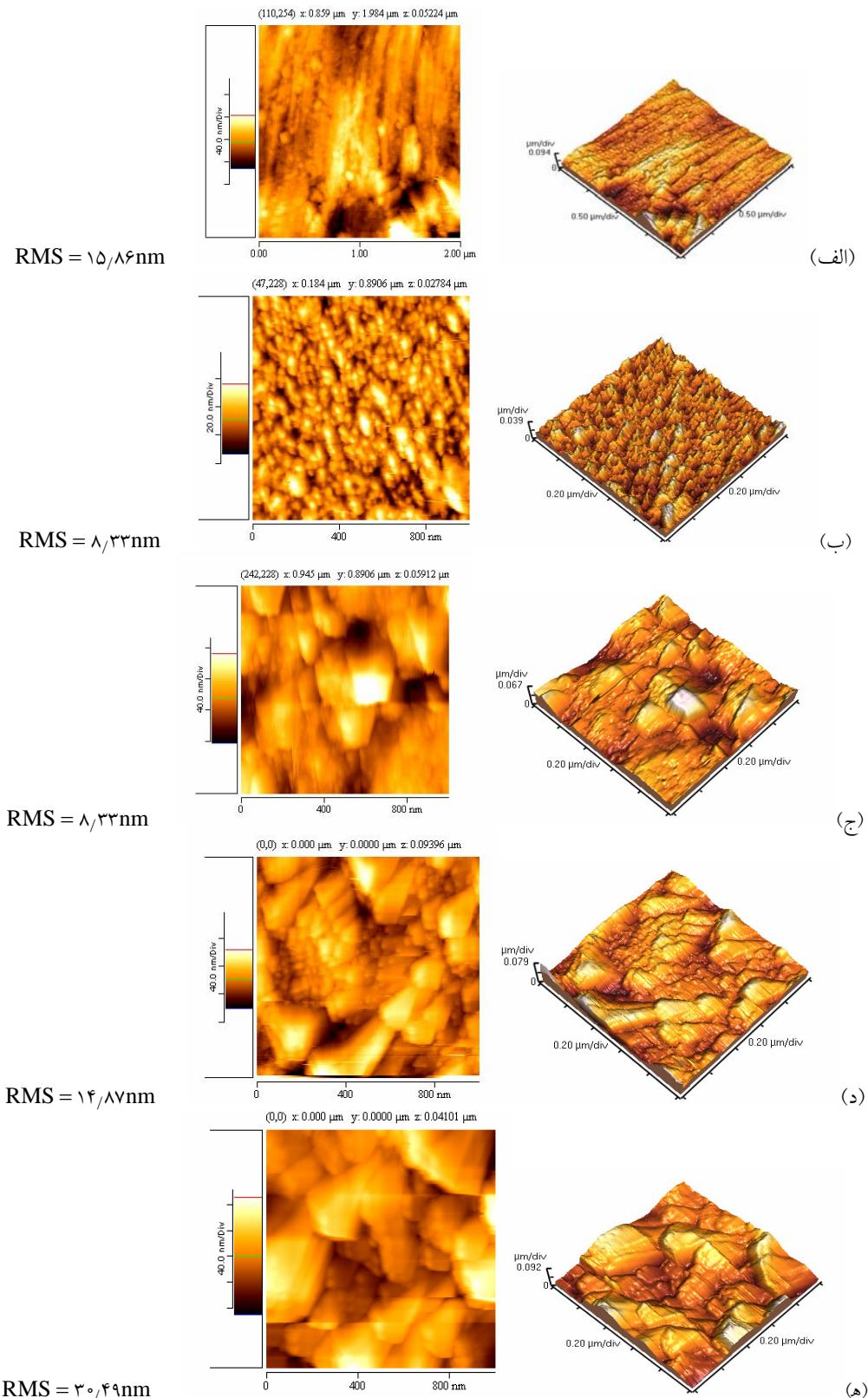
شکل ۲- تصویر میکروسکوپ نیروی اتمی دو بعدی و سه بعدی از سطح تیتانیم (الف): پولیش شده و اصلاح شده با (ب): ۱۰۰ درصد اسید فلوریدریک (ج): ۸۰ درصد اسید کلریدریک-۶ درصد اسید فلوریدریک-۱۴ درصد اسید فسفریک (د): ۸۵ درصد اسید کلریدریک-۶ درصد اسید فلوریدریک-۹ درصد اسید فسفریک (ه): ۸۰ درصد اسید کلریدریک-۱۰ درصد اسید فلوریدریک-۱۰ درصد اسید فسفریک، به مدت ۱۲۰ ثانیه و در دمای محیط.
