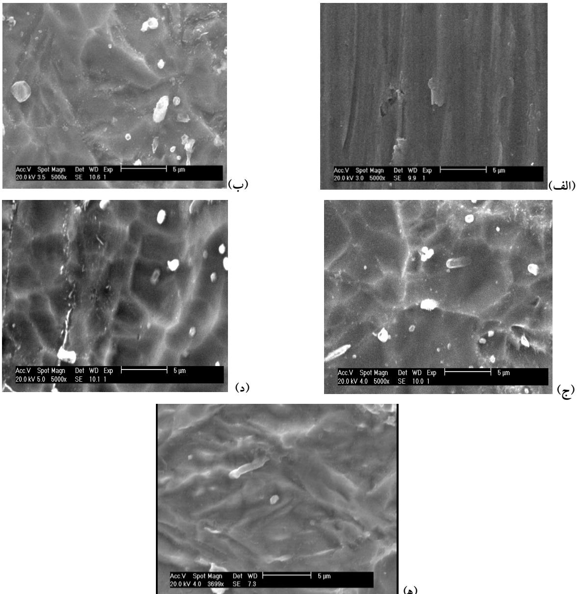
شکل ۱- تصویر میکروسکوپ الکترونی از سطح تیتانیم (الف): پولیش شده و اصلاح شده با (ب): ۱۰۰ درصد اسید فلوئوریدریک (ج): ۸۰ درصد اسید کلریدریک- ۶ درصد اسید فلوئوریدریک- ۱۴ درصد اسید فسفریک (د): ۸۵ درصد اسید کلریدریک- ۶ درصد اسید فلوئوریدریک- ۹ درصد اسید فسفریک (ه): ۸۰ درصد اسید کلریدریک- ۱۰ درصد اسید فلوئوریدریک- ۱۰ درصد اسید فسفریک، به مدت ۱۲۰ ثانیه و در درجه دمای محیط.
