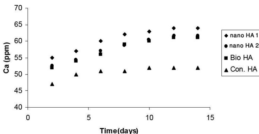
شکل ۶- نمودار تغییرات غلظت یون کلسیم محلول شبیه‌سازی شده بدن حاوی هیدروکسی آپاتیت نانوساختار تهیه شده به روش سل-ژل (nano HA1)، هیدروکسی آپاتیت نانوساختار تهیه شده به روش فعالسازی مکانیکی (Con. HA)، آپاتیت بیولوژیکی (Bio HA) و هیدروکسی آپاتیت تجارتی (nano HA2).
