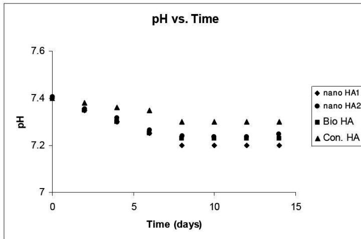
شکل ۷- نمودار تغییرات درجه اسیدی (pH) محلول شبیه‌سازی شده بدن حاوی پودر هیدروکسی آپاتیت نانوساختار تهیه شده به روش سل-ژل (nano HA1)، پودر هیدروکسی آپاتیت نانوساختار تهیه شده به روش فعالسازی مکانیکی (Con. HA)، آپاتیت بیولوژیکی (Bio HA) و هیدروکسی آپاتیت تجاری (nano HA2).
