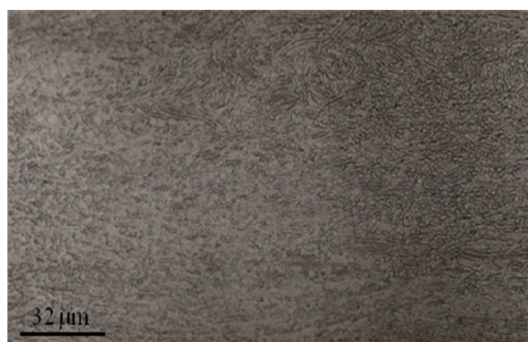
شکل (۴-د) - ریز ساختار نهایی نمونه آزمایش شده در دمای ۸۵۰ درجه سانتیگراد و سرعت کرنش 1 \times 10^{-4} \text{ s}^{-1}
