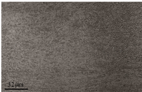
شکل (۴-د) - ریز ساختار نهایی نمونه آزمایش شده در دمای ۸۵۰ درجه سانتیگراد و سرعت کرنش 10^{-1} \text{ s}^{-1}
