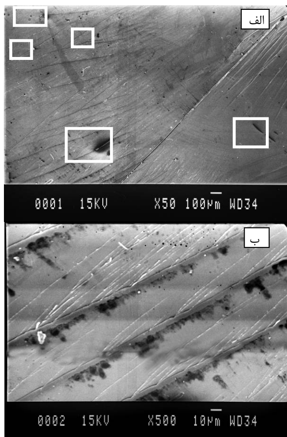
شکل ۵ - ریزساختار سطح شکست رزین فنولیک
