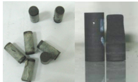
شکل ۱۰ - نمونه‌های کامپوزیتی قبل و بعد از انجام آزمایش سوزش نمونه‌ها
