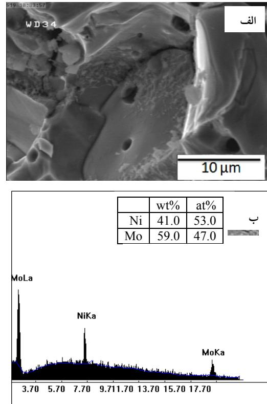
شکل ۶- (الف) تصویر SEM سطح شکست نمونه MN1.5
