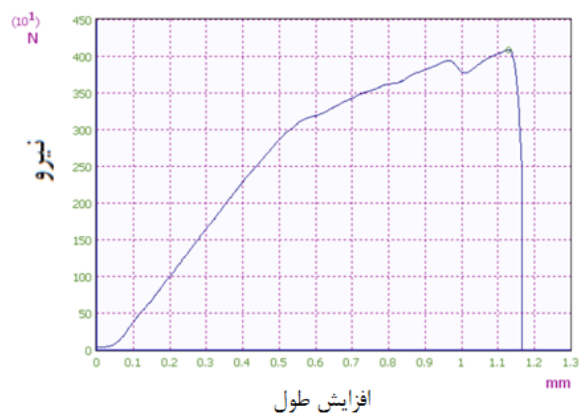
شکل ۶- نمودار نیرو-تغییر طول مربوط به نمونه لحیم شده با فلز پرکننده پایه تیتانیوم با فاصله توقف ۰/۰۴ میلی متر
