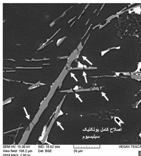
شکل ۱۴- ترک های ایجاد شده روی ترکیب بین فلزی \beta در نمونه
