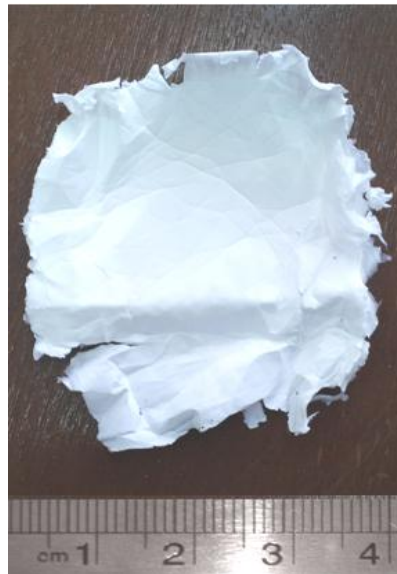
شکل ۱- تصویر الیاف شیشه زیست فعال پس از الکترونیسی با ولتاژ ۱۹ کیلو وات، نرخ تغذیه ۰/۸ میلی‌لیتر بر ساعت و فاصله نازل تا جمع‌کننده (جمع‌کننده ثابت) ۱۰۰ میلی‌متر
