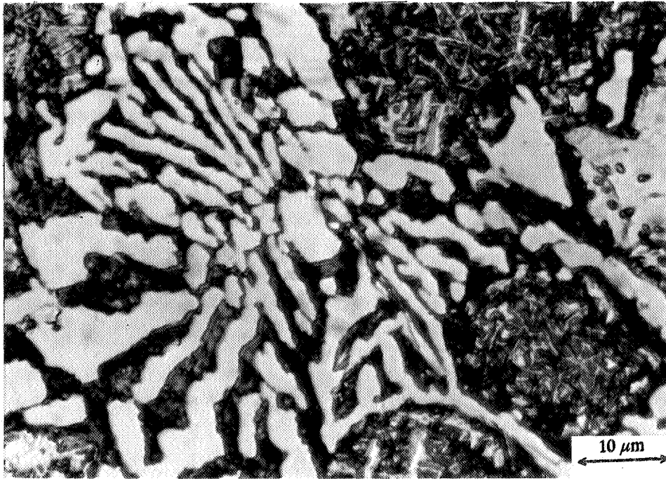
شکل ۲- ساختار میکروسکوپی چدن نیکل سخت عملیات حرارتی شده با ۲/۳ درصد کربن شامل زمینه مارتنزیت و فاز کاربید
