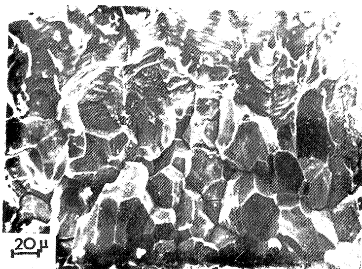
شکل ۱۰ : تصویر میکروسکوپی الکترونی از سطح مقطع شکست نمونه‌های غوطه‌ور شده در محلول، شامل خوردگی بین دانه‌های در کنار رده‌ها و شکست مکانیکی نرم در بقیه نمونه .
