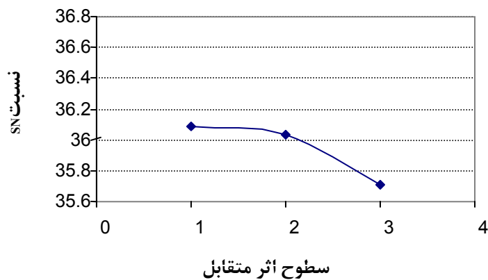
شکل ۱۲- تأثیر اثر متقابل غلظت اسید و دما، ظاهر شده در ستون سوم آرایه بر نسبت SN
