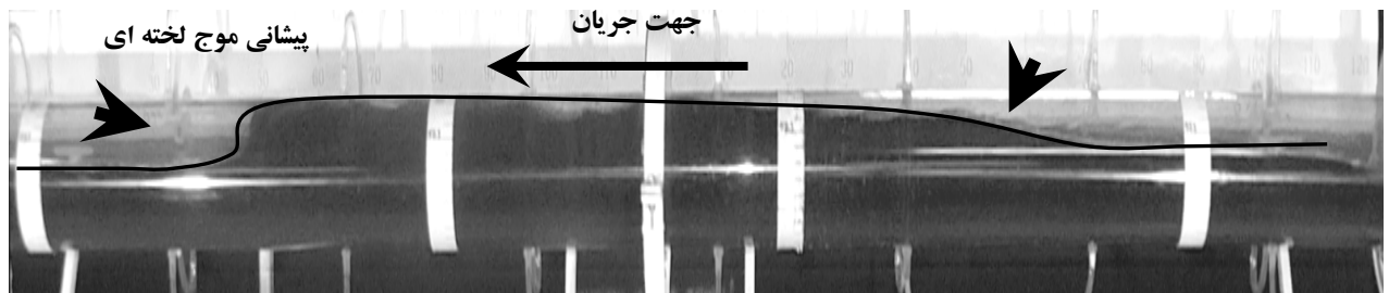
شکل ۶- نمونه‌ای از لخته تشکیل شده در مجرا
