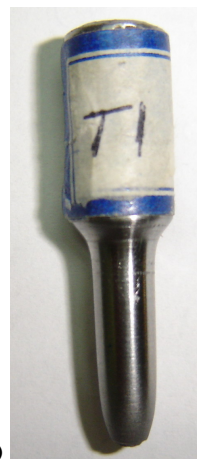
شکل ۱۳- نمونه کششی پس از شکست الف- حاصل از آزمایش، ب- حاصل از شبیه‌سازی
