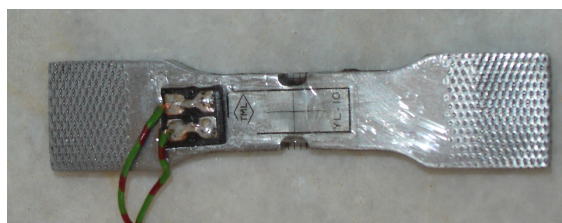
شکل ۲- نمونه شیاردار تهیه شده برای تعیین پارامترهای آسیب
