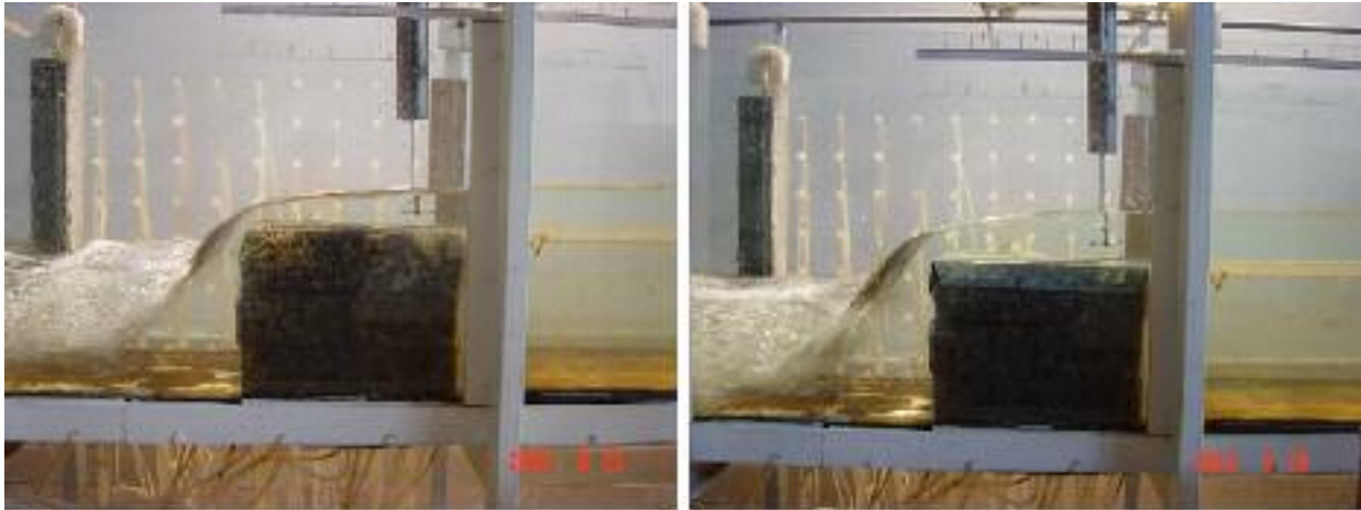
شکل ۳ - شکل سمت چپ تاج نفوذپذیر و سمت راست تاج نفوذ ناپذیر
