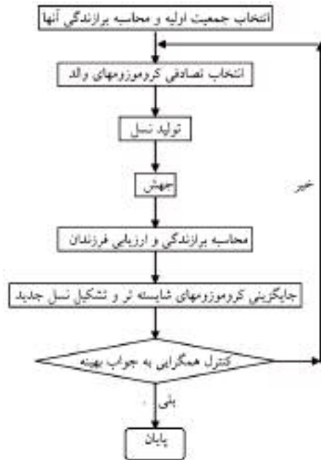
شکل ۲ - فرایند به کارگیری الگوریتم ژنتیک
