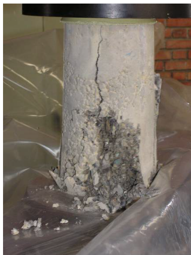
شکل ۱- وضعیت شکست در بتن معمولی
