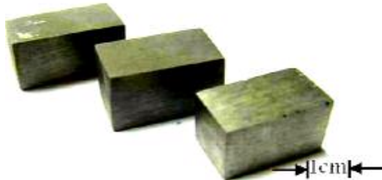
شکل ۱۴- نمایی از نمونه‌های استاندارد محاسبه دانسیته.
