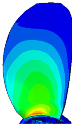
شکل ۲۴- تنش فون میزز ۲۹ در پره برحسب پاسکال
