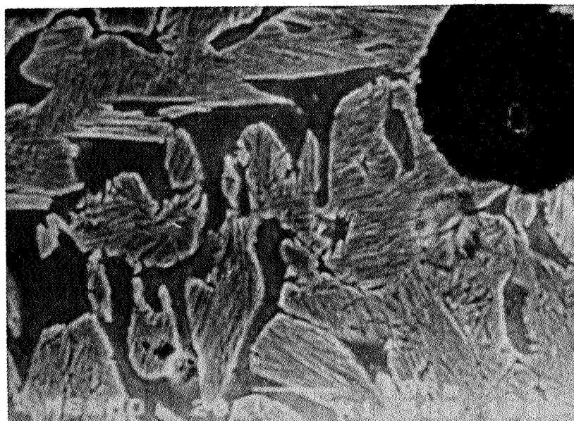
شکل ۱۰ - تصویر میکروسکوپی الکترونی از نمونه نشان داده شده در شکل شماره ۹ [در این ساختار آستنیت باقیمانده (نواحی هموار) و مناطق دانه‌ای فریت-بینیتی (نواحی ناهموار) کاملاً مشخص اند]
