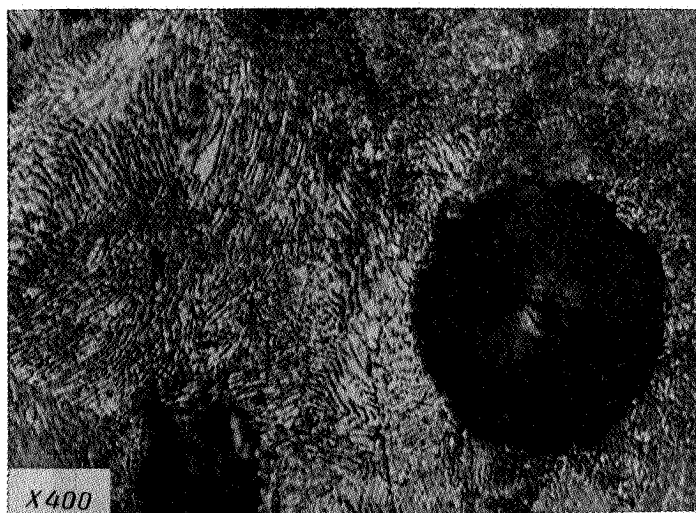
شکل ۶ - ساختار میکروسکوپی نوری زمینه متشکل از پرلیت در آلیاژ ۳ در حالت ریختگی
