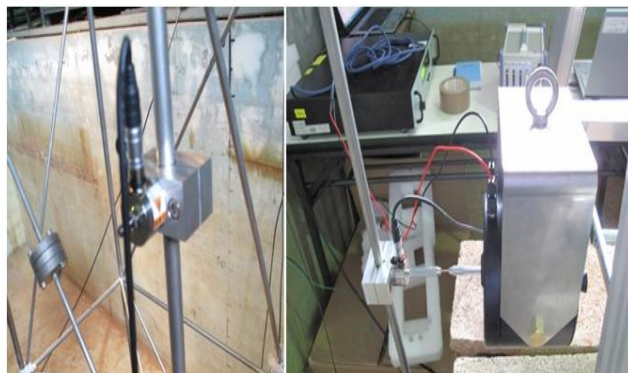
شکل ۲- ارتباط بین آمپلی فایر، لرزاننده الکترو دینامیکی، نیروسنج و سازه مدل
