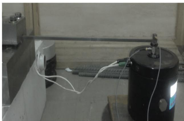
شکل ۳- تیر یک سر گیردار تحت آزمایش
