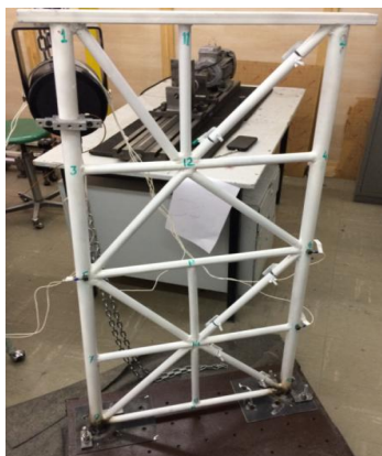
شکل ۶- سازه مدل قاب فولادی دوبعدی مورد استفاده در تست‌های آزمایشگاهی
