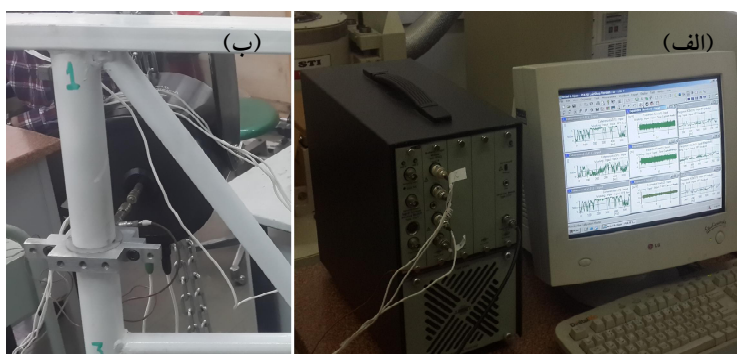
شکل ۱۰- الف) ابزار مورد استفاده برای تست ارتعاش آزمایشگاهی و ب) لرزاننده متصل به پایه مدل سکو
