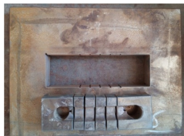
شکل 4- محل برش و بررسی ترک روی نمونه استاندارد جوشکاری شده بر اساس استاندارد ISO17642-2 [19]
