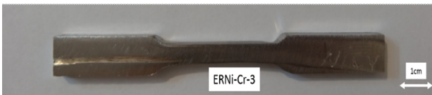
شکل ۲- نمونه‌های مربوط به آزمایش کشش تهیه شده از نمونه‌های جوشکاری شده با فلزات پرکننده مختلف.
