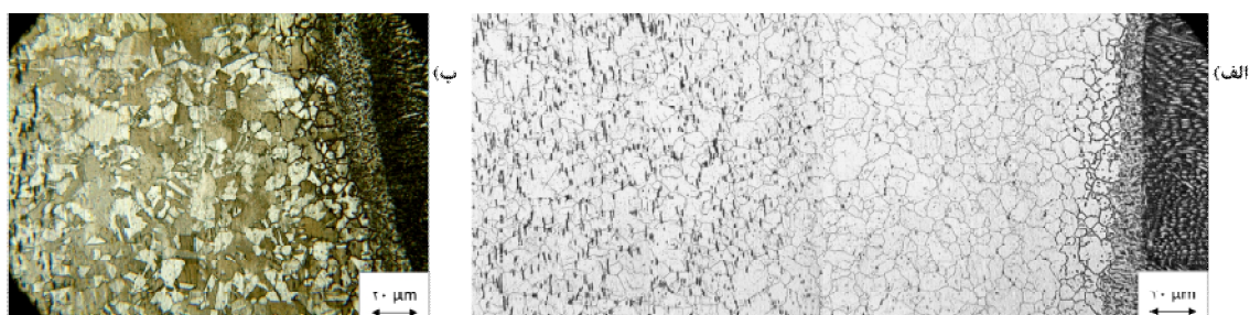
شکل ۱۰- درشت شدن دانه ها در ناحیه HAZ برای جوش MIG2
