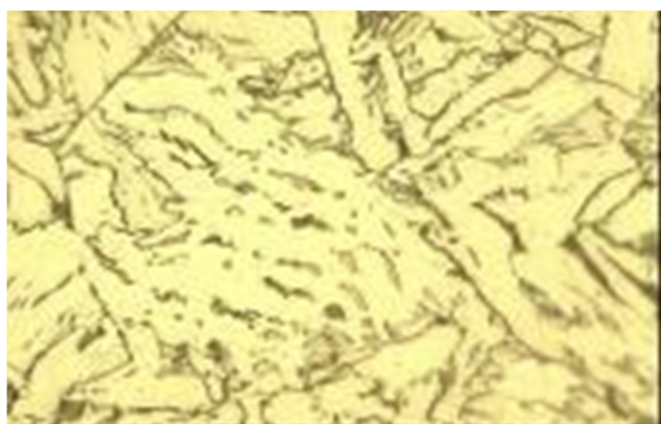
شکل 15- تصاویر میکروسکوپی پاس سطح
