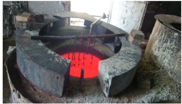
شکل 4- عملیات حرارتی نمونه ها در کوره
