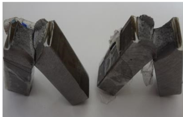
شکل 16- نمونه شکست بعد از آزمون ضربه
