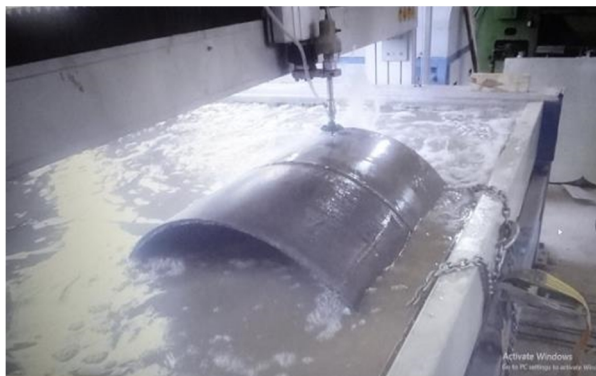
شکل 2- برش لوله توسط واتر جت
