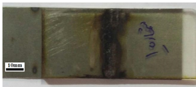
شکل ۶ - نمونه های جوشکاری St12 و پلی کربنات
