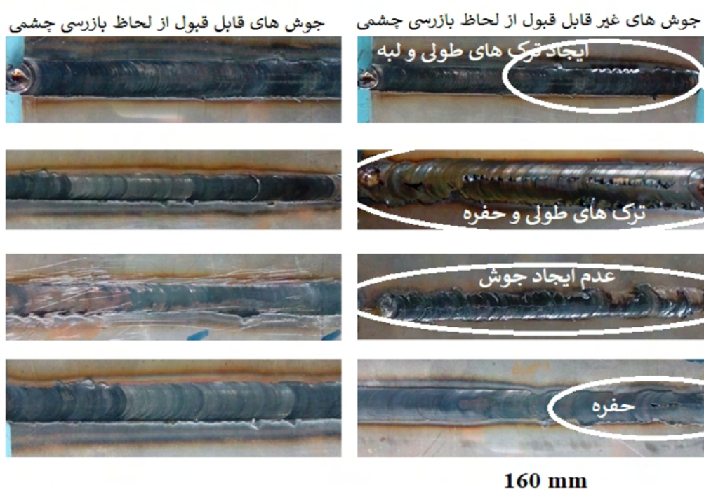
شکل 6- چند نمونه از اتصالات سالم و معیوب، جوشکاری شده با پارامترهای شکل (4)
