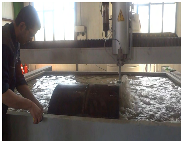
شکل ۶- برشکاری لوله توسط واترجت
