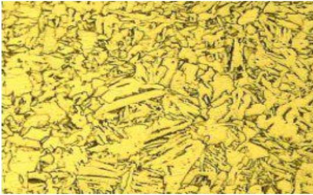
شکل ۱۷- تصاویر میکروسکوپی پاس سطح
