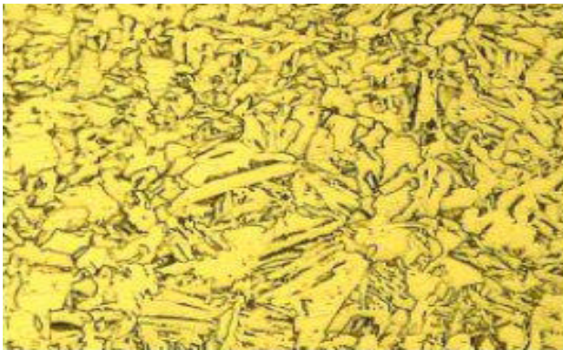
شکل ۱۷- تصاویر میکروسکوپی پاس سطح
