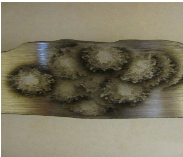
شکل ۸- نمونه های آزمون کوانتومتری
