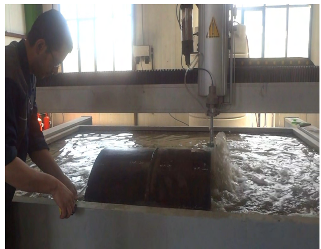
شکل ۶- برشکاری لوله توسط واترجت
