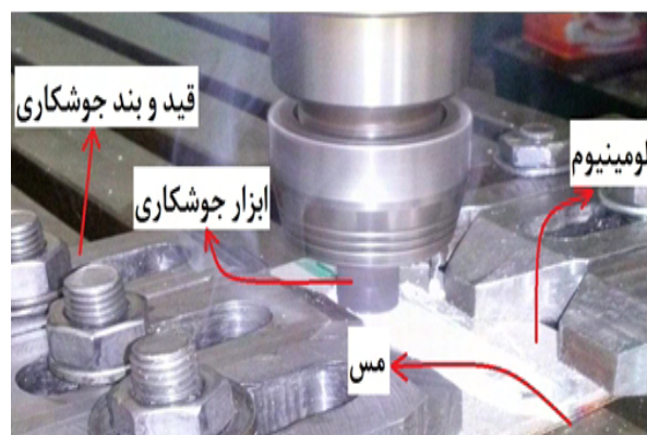
شکل ۱- تصویر فرایند جوشکاری اصطکاکی اغتشاشی
