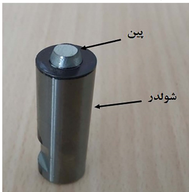
شکل 1- تصویر پین و شولدر جوشکاری اصطکاکی همزنی.
