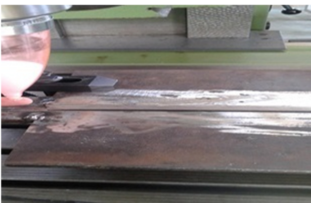
شکل 2- توزیع نانو مواد در طرح اتصال جوش
