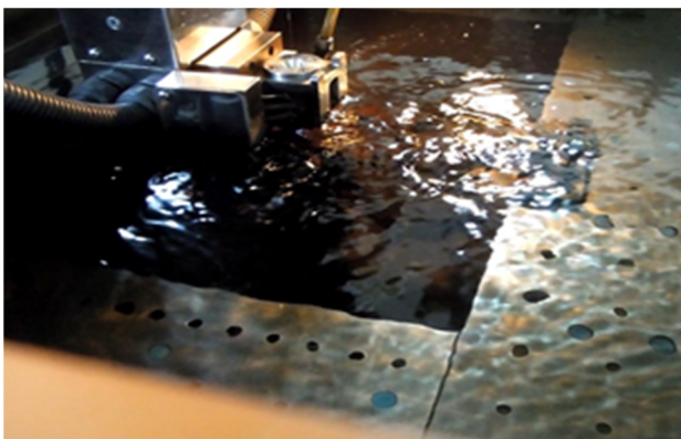
شکل 1- برشکاری با استفاده از دستگاه واترجت
