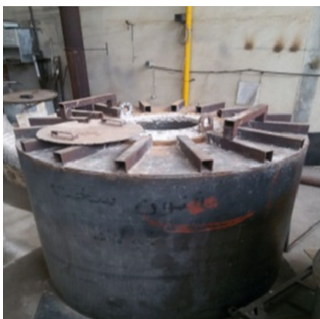
شکل 4- کوره عملیات حرارتی کربوره کردن
